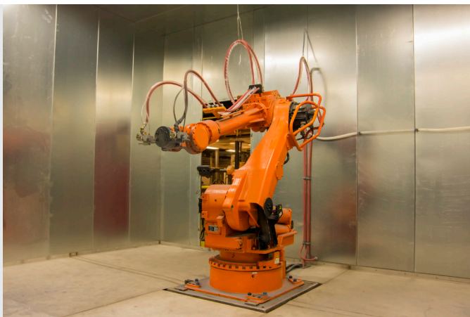
▲ Aplicación Robótica del revestimiento de alta tecnología
